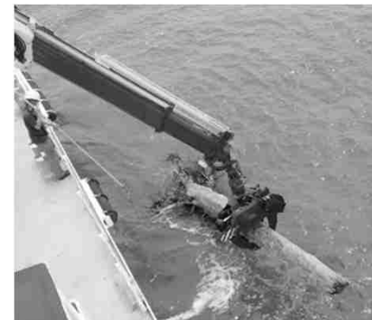
多関節クレーンによる流木の回収状況
