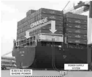
停泊中船舶への 陸上電力供給
