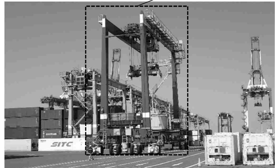
遠隔操作RTG
