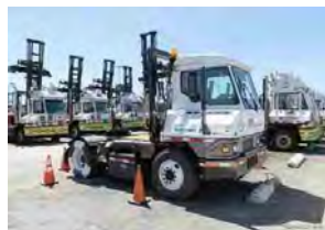
コンテナ用FCEVトラクター (構内用) (出典)トヨタ自動車HP
