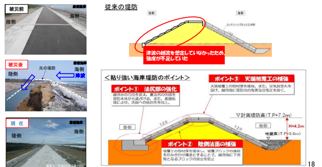
図9 粘り強い構造(堤防)
