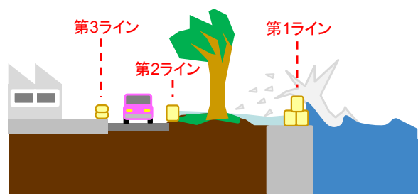
土のうによる3重防護のイメージ
