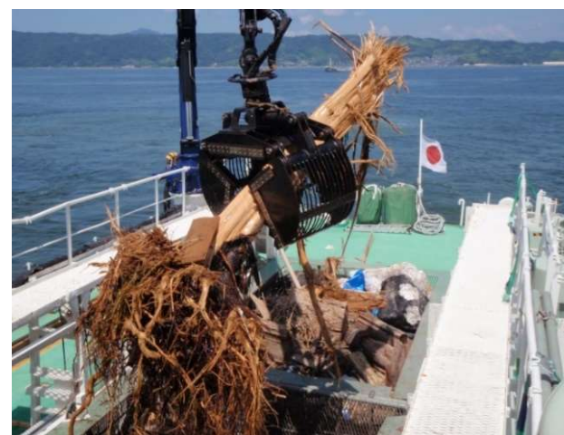
流木回収状況
